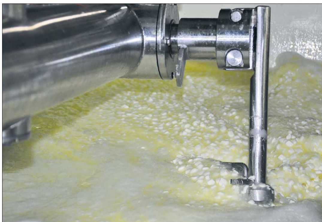
Bei der Mozzarella-Herstellung wird genau wie bei jeder Käseherstellung der Bruch von der Molke getrennt. Dieser wird üblicherweise das Schmelzwasser (siehe nächstes Bild) beigemischt.
